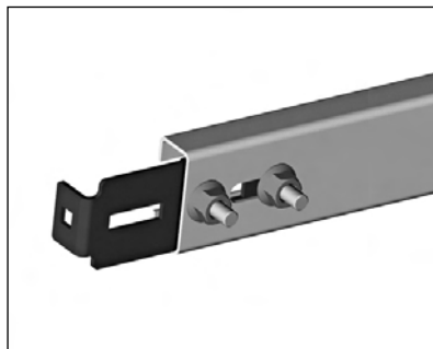
Рис. 13. Установка кронштейна мерной планки
